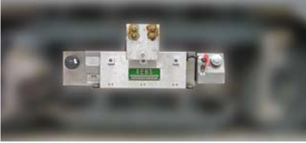
Système de pulvérisation avec unité compresseur dans le boggie.
